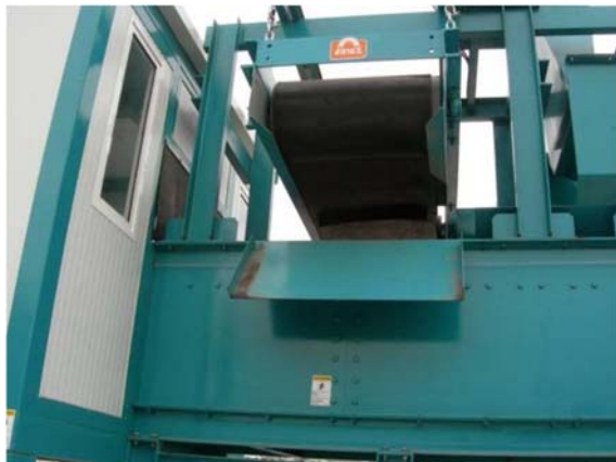
Separador magnético sobre la cinta de transporte
